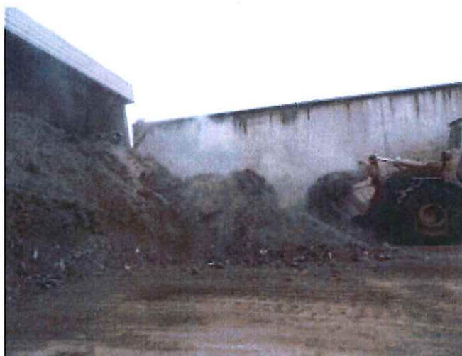
Vapeur d'eau s'évaporant des mâchefers en maturation
